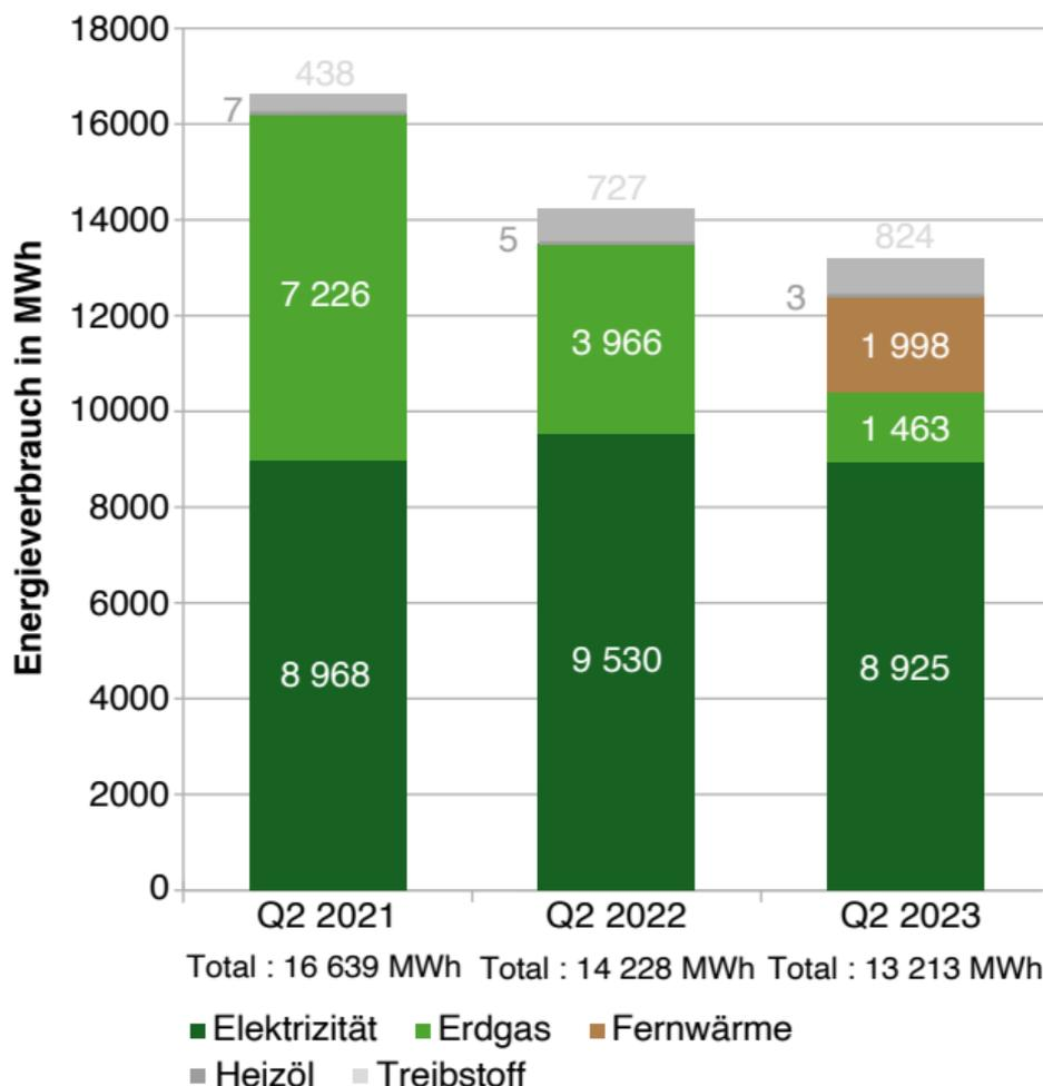
Vier verschiedene Energieträger stellen die am Flughafen benötigte Energie zur Verfügung: Elektrizität, Erdgas, Heizöl und Treibstoff. Die Graphik zeigt den Verbrauch der von der Flughafendirektion bereitgestellten und verteilten Energiearten. Die Flugzeugbetankung ist hierin nicht enthalten.
