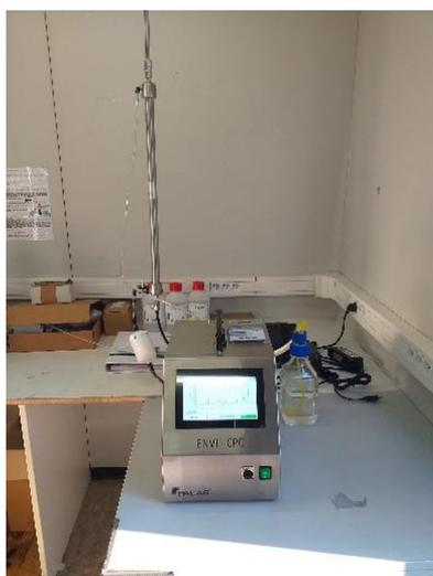
Abbildung 5: Das Vergleichsgerät, der Condensation Particle Counter (CPC) im Inneren der Messstation
