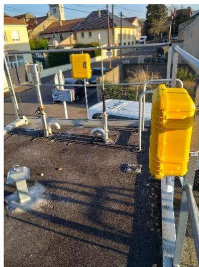
Abbildung 6: Partetector 2-Geräte in ihren gelben Schutzkästen auf dem Dach der Messstation
