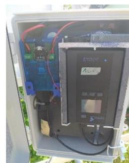
Abbildung 2: Der Partector 2 in seinem wasserdichten Schutzgehäuse
