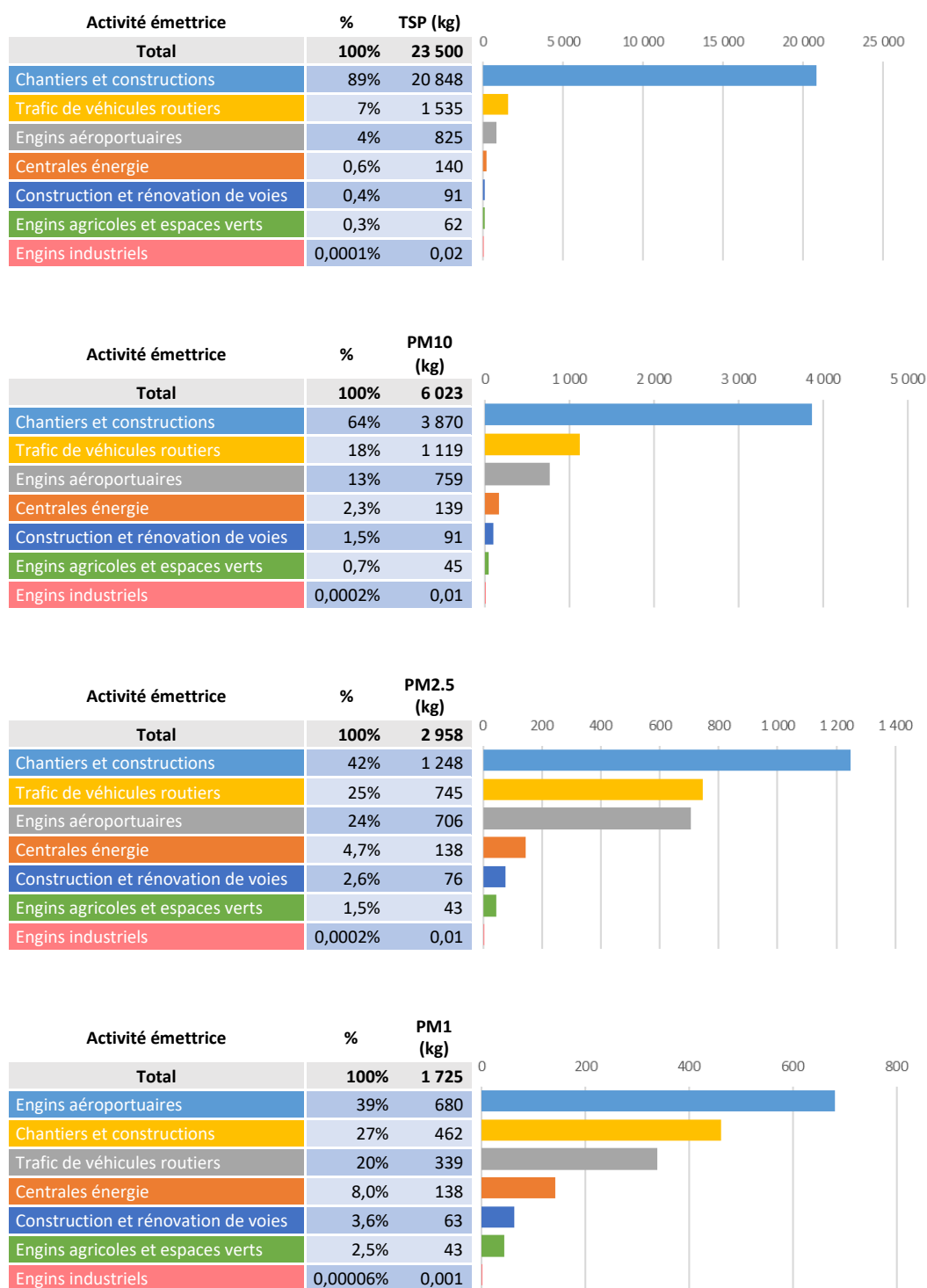
Figure 30 : Emissions de particules au sol pour la plateforme aéroportuaire de Bâle Mulhouse en 2019
