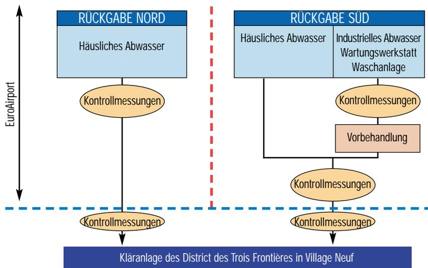
Das Schema zeigt das Prinzip der Abwasserkanalisation und der Abwasserrückgabe auf dem Flugplatzgelände des EuroAirport. Das Netz für die Abwassersammlung ist in die zwei Zonen Nord und Süd aufgeteilt. Die Abwasserrückgabe an das Kanalisationsnetz des District des Trois Frontières erfolgt an zwei verschiedenen Verbindungspunkten. Im Süden werden zudem auch die Abwässer der industriellen Vorbehandlungsanlage aufgenommen, welche von den Unterhaltsbetrieben stammen.
