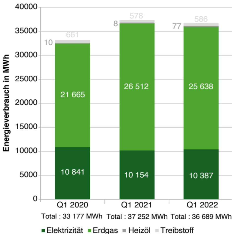
Vier verschiedene Energieträger stellen die am Flughafen benötigte Energie zur Verfügung: Elektrizität, Erdgas, Heizöl und Treibstoff. Die Graphik zeigt den Verbrauch der von der Flughafendirektion bereitgestellten und verteilten Energiearten. Die Flugzeugbetankung ist hierin nicht enthalten.
