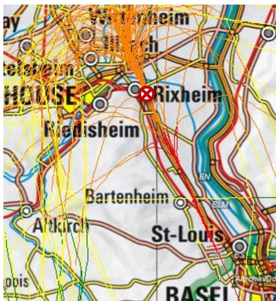
La figure ci-contre montre l'emplacement du point de mesure par rapport aux tracés radars relatifs aux atterrissages en piste 15 pendant une journée, soit ici l'exemple du 02/08/2016. La station est située directement sous l'axe d'approche de l'ILS 15.
