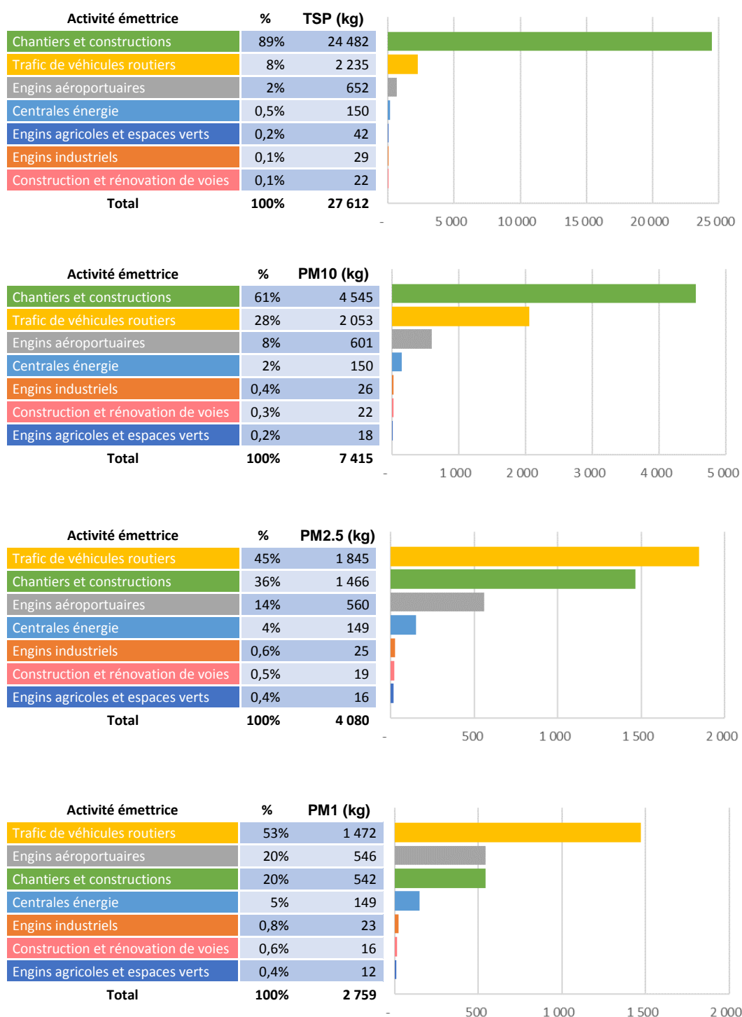
Figure 21 : Emissions de particules au sol pour la plateforme aéroportuaire de Bâle Mulhouse en 2015
